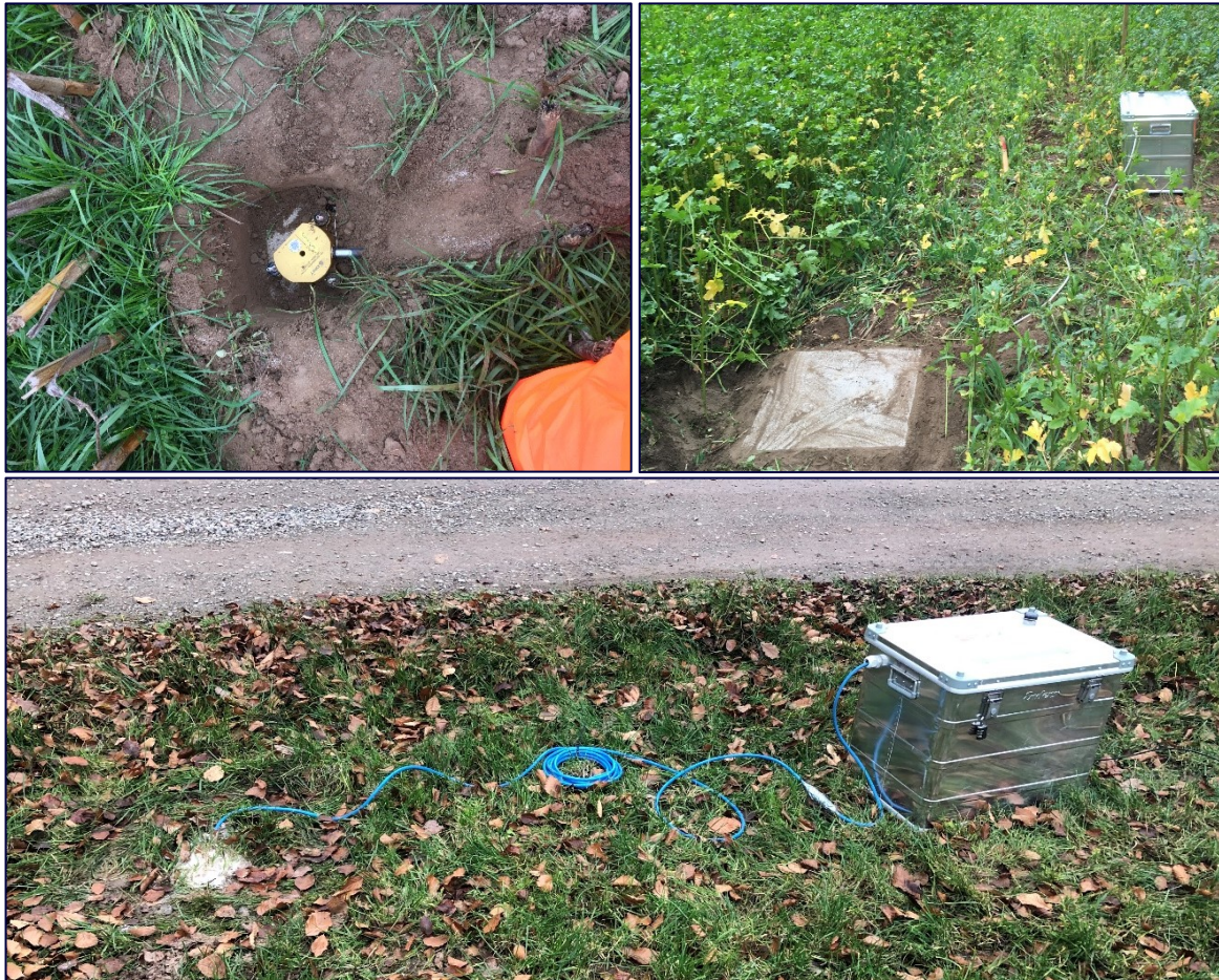
Abbildung 8: Messaufbau einer mobilen seismischen Messstation. links: Sensor auf Steinplatte in 50 cm Aushub. rechts: wettergeschützter Aushub und Digitalisierereinheit in Alukiste. unten: flache Bohrlochsonde und Digitalisierereinheit in Alukiste.
